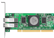
connecteur PCI-X 2.0 64 bits
